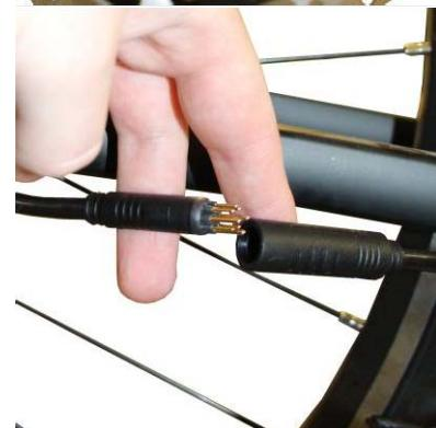
! Při zapojování konektoru dávejte pozor, aby vylisované šipky na obou částech konektoru směřovaly proti sobě. Konektor spojte dostatečnou silou. Nedostatečné zasunutí můžezpůsobit nefunkčnost motoru nebo poškození konektoru.
