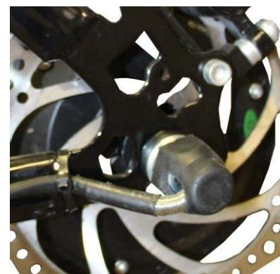
! Při montáži kola se zapleteným motorem dbejte na správnou pozici středové osy vybráním směrem dolů. Kabel musí do motoru vstupovat zespoda.
